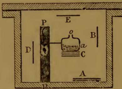
milieu d'une enceinte close. Diverses plaques A, B, C, D, E placées dans l'enceinte deviennent radioactives au bout d'un jour d'exposition. L'activité est la même, quelle que soit la nature de la plaque, à dimensions égales (plomb, cuivre, aluminium, verre, ébonite, cire, carton, paraffine). L'activité d'une face de l'une des lames est d'autant
